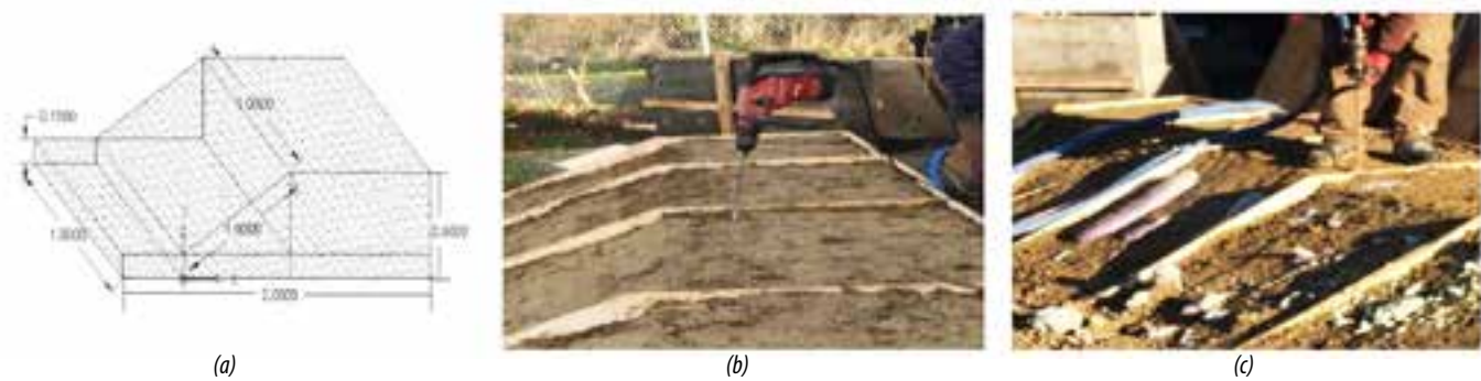
Figure 1 : Plan de digue en terre (a) dimensions du spécimen (b) avant injection (c) après injection.
