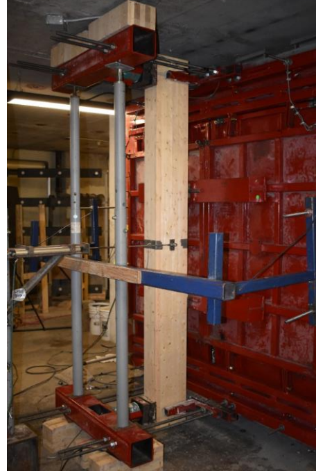
(b) Actual Glulam Test Assembly
