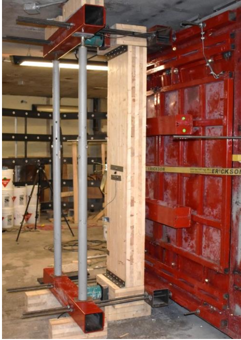
(a) Actual CLT Test Assembly
